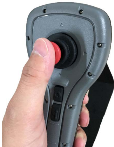
ジョイスティックによるカメラ湾曲操作 親指を倒した方向に先端カメラが曲がります。
